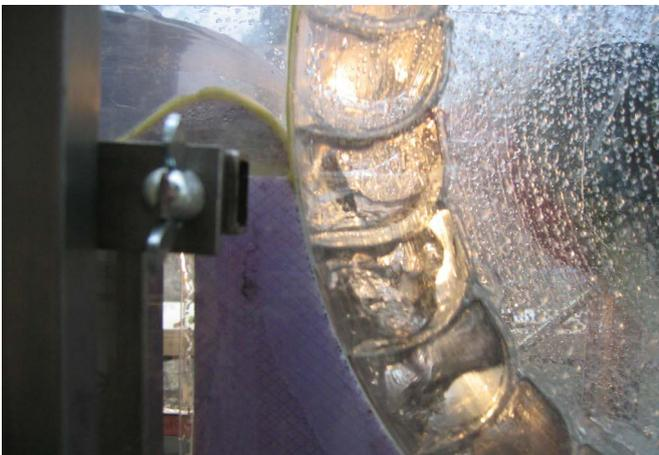
detail einlauf mittelschlächtiges wasserrad
