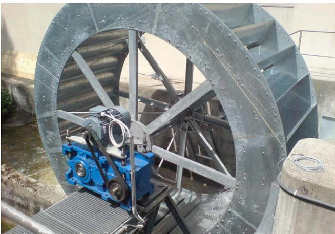
ansicht des getriebes mit dem generator
